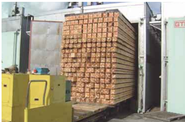
木材乾燥施設による乾燥木材の生産
